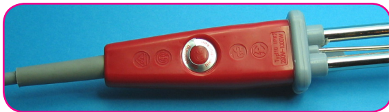
handvat met resetknop temperatuurbeveiliging
